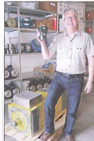
Jørn Olerud med en 210 kW spesialmotor for oljeboremaskineri. I hånda holder han en 200 W girmotor.
